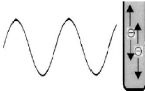
Şekil 2.5 Bir çözeltideki yüklü parçacıkların elektrik alanını takip etmesi (Lidström vd., 2001)
