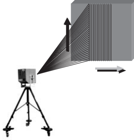
Şekil 2.3 Yersel tarayıcının çalışma prensibi (Kıvılcım,2005)
