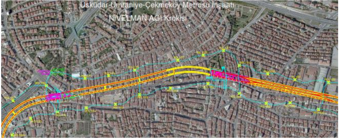
Şekil 3.26 Üsküdar – Ümraniye – Çekmeköy metrosu nivelman ağı [5]
