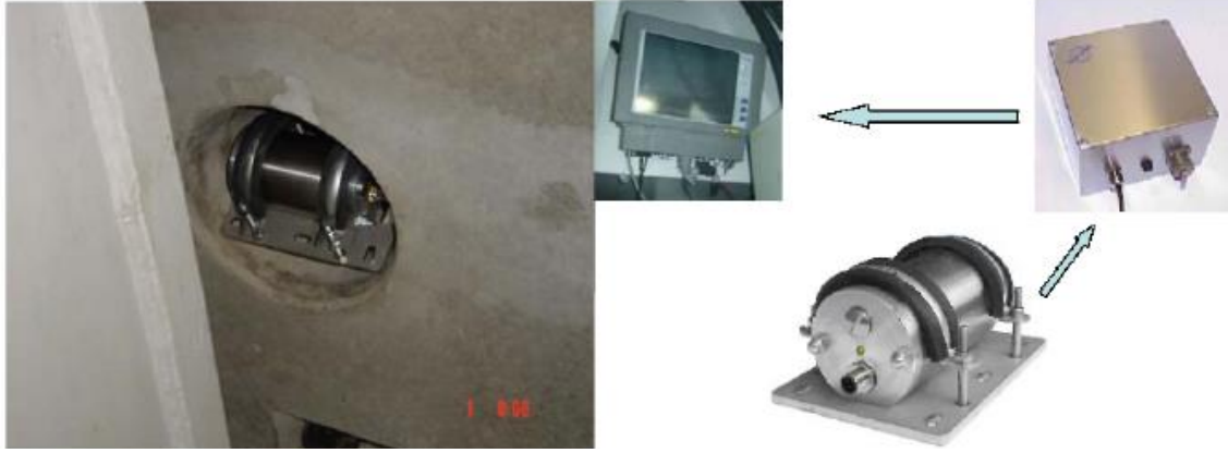
Şekil 5.12 Ring konverjans ölçüm sistemi ve bileşenleri (VMT, 2005-a)
