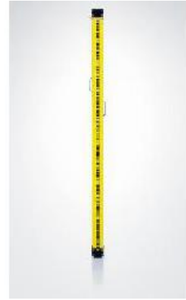
Şekil 3.27 Leica DNA03 sayısal nivo, ahşap sehpa, barkotlu invar mira
