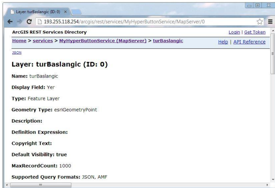
Şekil 2. 10 REST tabanlı web servisinin katman isteği yanıtı
