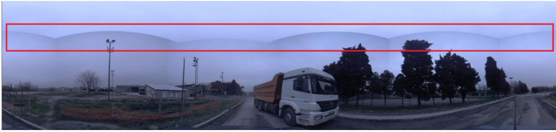
Şekil 3. 13 Kaynaşma genişliği = 0 durumu (görüntü ofseti oluşmuştur)
