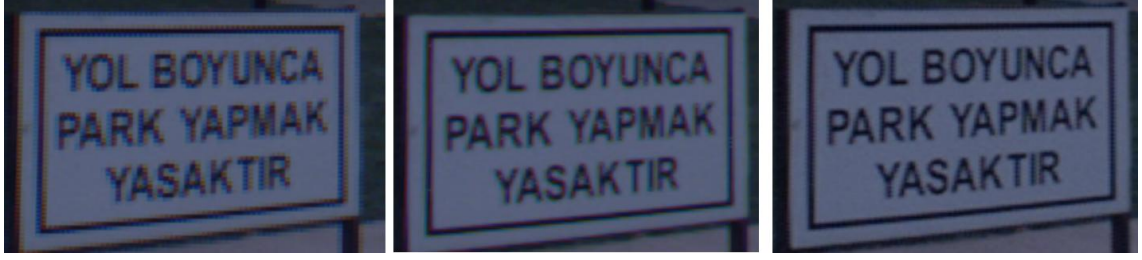
Şekil 3. 8 Renk işleme yöntemine göre sonuçlar, Nearest Neighbor(solda), Edge Sensing(ortada), High Quality Linear(sağda)
