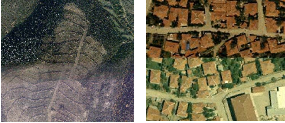
Şekil 6.13 10 m. aralıklı eş yükseklik eğrisi kullanılarak üretilmiş 1/5.000 ölçekli ortofoto haritada meydana gelebilecek hatalar.
