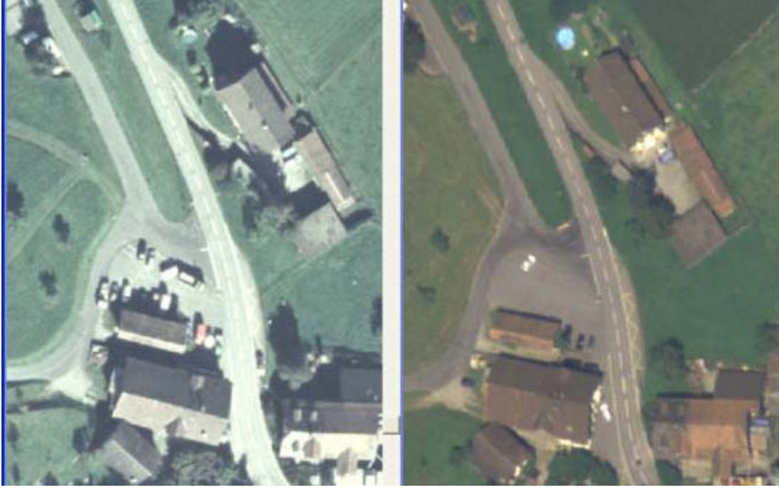
Şekil 4.11 RC30(21cm) kamera(solda) ve ADS40(30cm) kamera ile çekilmiş görüntüler
