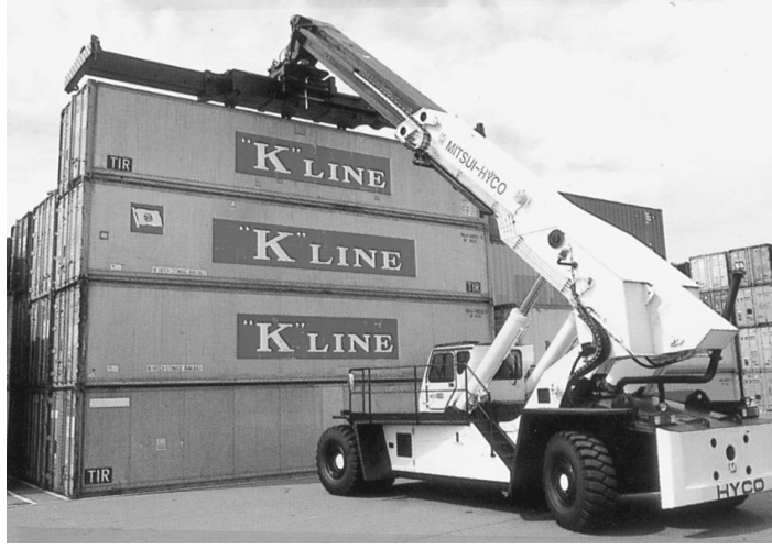
Şekil 4.15 Konteynerlerin teleskopik bumlu yüksek erişimli istifleyici tarafından istiflenmesi, (Memos, 2004)
