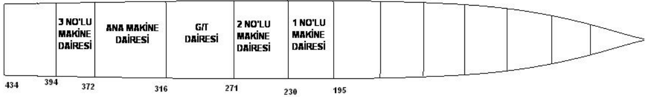
Şekil 1.1 Gemi makine daireleri yerleşim planı
