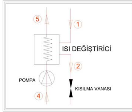
Şekil 3.4 Tek kademeli H 2 O - LiBr eriyikli absorpsiyonlu soğutma çevrimi ısı değiştiririci için akışkan giriş çıkış şeması
