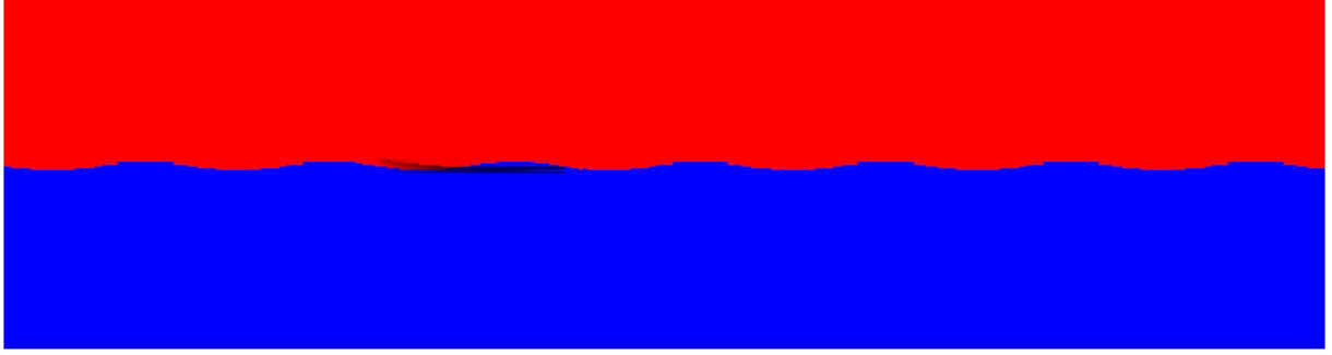
Şekil 6.2 Başlangıç koşulu olarak serbest su yüzeyi (lacivert bölge su akışkanını, kırmızı bölge hava akışkanını temsil etmektedir)
