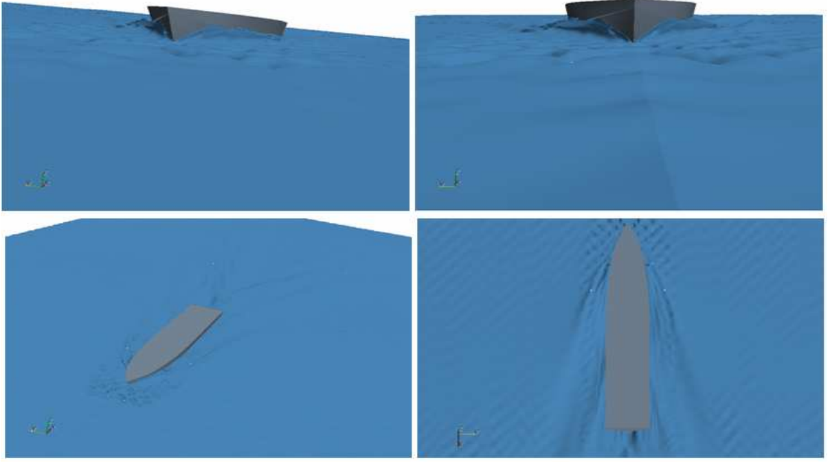
Şekil 4.7 20 knot seyir hızında tekne etrafında oluşan dalga deformasyonları
