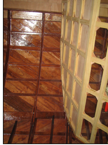
Şekil 4.11 Baş çatışma perdesinin konstrüksiyonu
