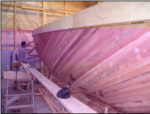
Şekil 4.9 Dış kaplama laminasyonu
