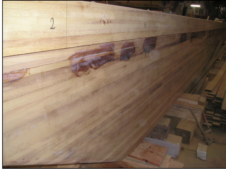
Şekil 4.3 Omurga laminasyonundaki hatalar
