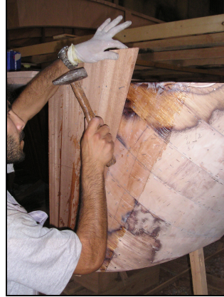
Şekil 4.8 Kıç ayna dış kaplama laminasyonu
