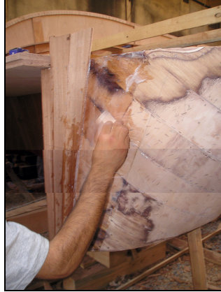
Şekil 4.8 Kıç ayna dış kaplama laminasyonu
