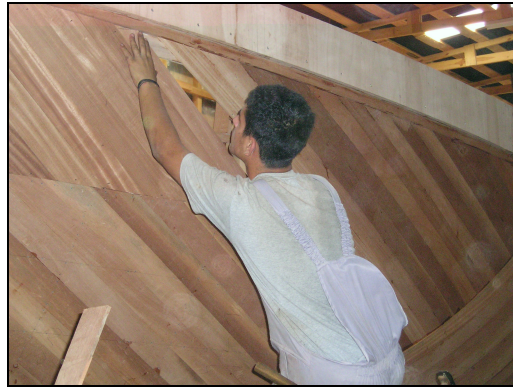
Şekil 4.9 Dış kaplama laminasyonu
