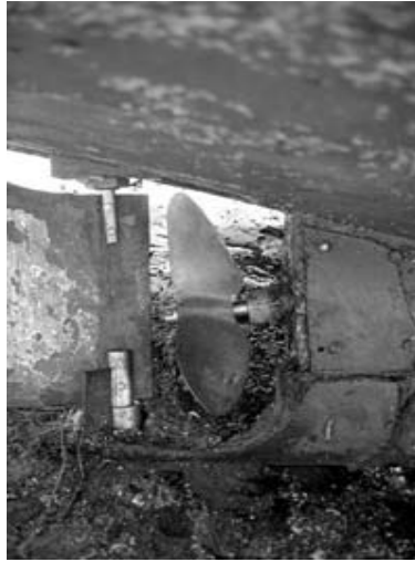
Şekil 2.5 Tekne ve kanat ucu arasında çok küçük topuk açıklığı (J. WILSON)
