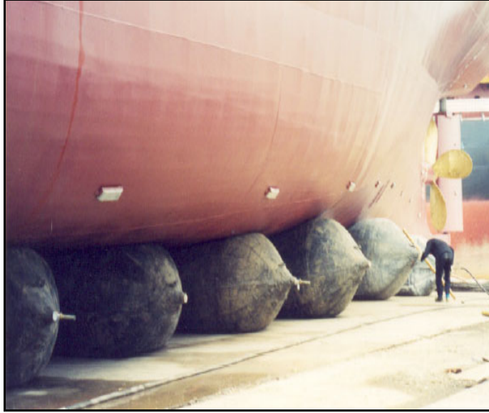
Şekil 7.17 Air-bag kullanımı ile geminin denize indirilmesi.
