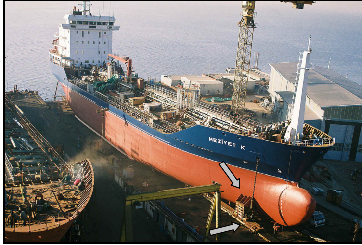
Şekil 7.8 Kızakların ve papetlerin yerleşimleri. [8]
