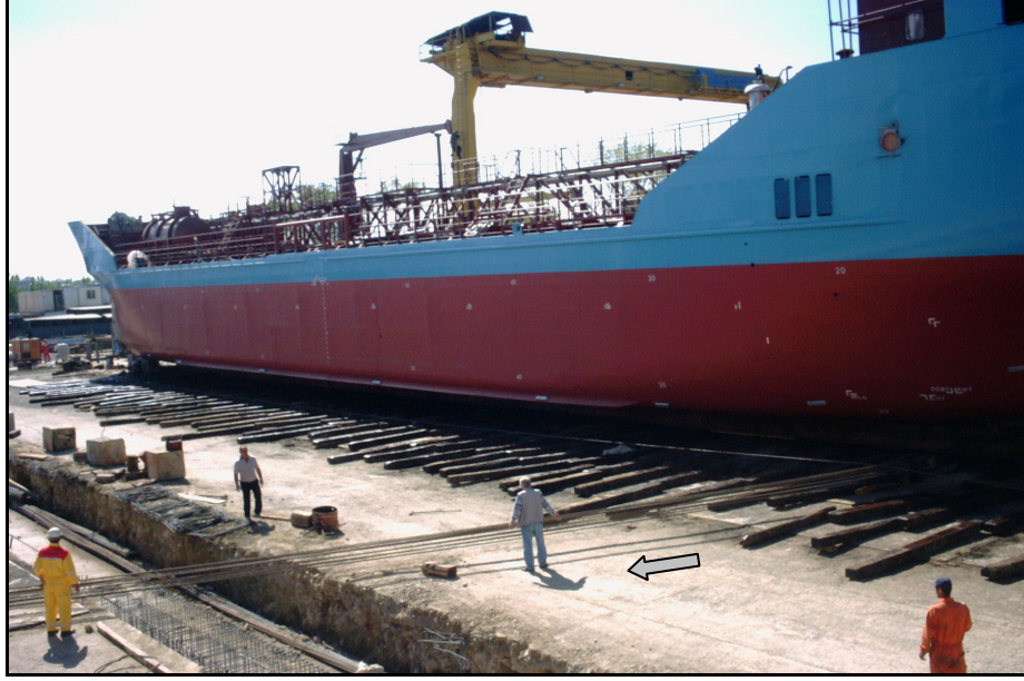
Şekil 7.15 Uygun doğrultu için yana doğru kaydırma operasyonu.
