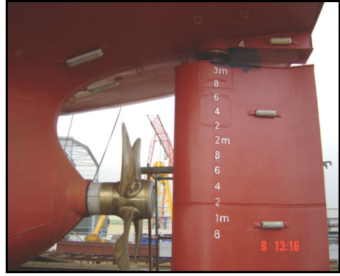
Şekil 4.10 Dümen yelpazesi ve şaft bağlantısı.
