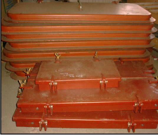
Şekil 6.15 Çelik kapıların depolanması.
