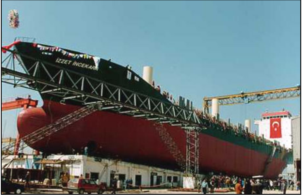
Şekil 6.2 İnşa kizağı ve üzerindeki gantry servis kreyni. [12]
