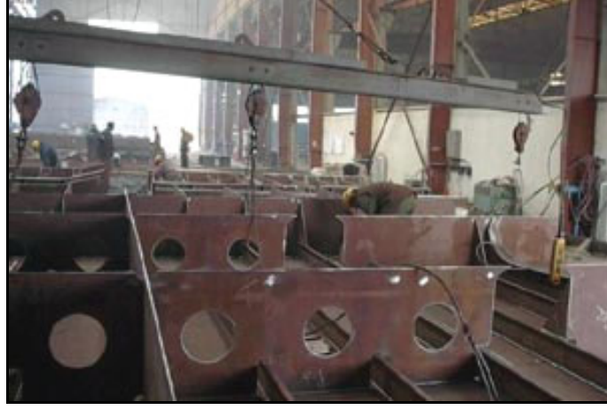
Şekil 6.34 Gruplu panelin imalat aşaması. [15]
