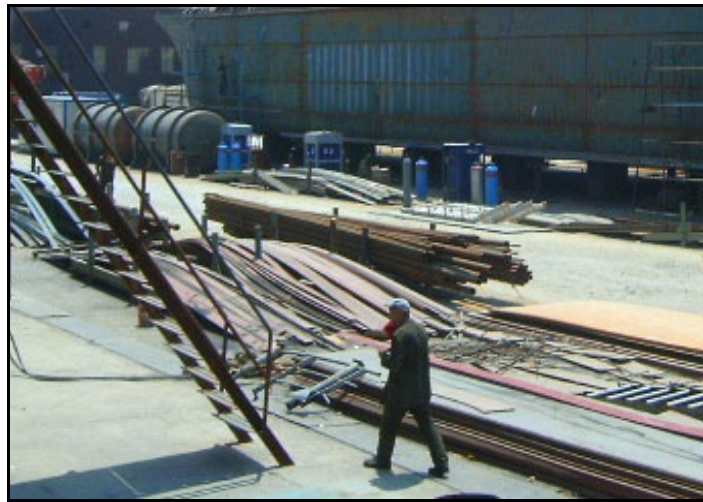
Şekil 6.7 Siyah boruların açık sahadaki istif sepetlerinde stoklanması.
