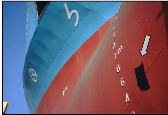
Şekil 6.55 Onarımına başlanmış boya hasarı (touch-up işlemleri).
