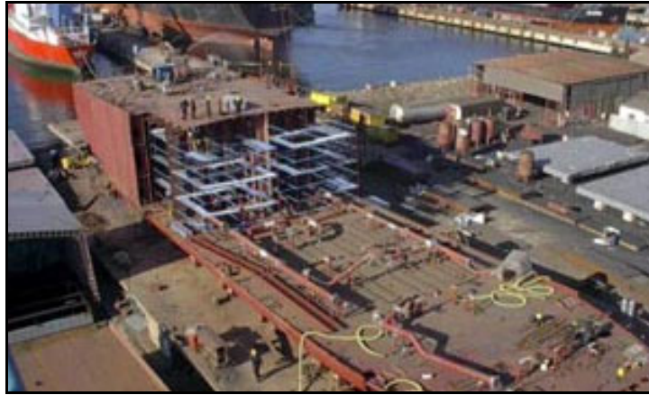
Şekil 6.46 Kızakta blok montajı devam eden bir tankerin çelik teknesi. [15]
