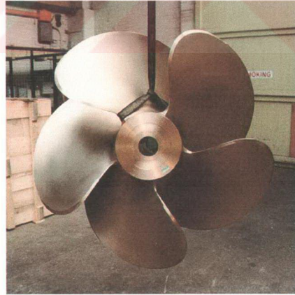
Şekil 2.10 Tek parça beş kanatlı sol dönüşlü bir pervane
