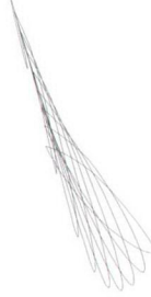
Şekil 7.28 Tanker pervanesi kanat kesitleri
