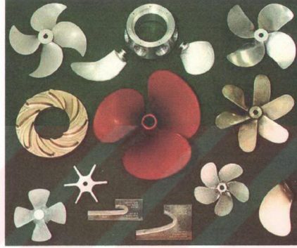
Şekil 2.9 Sabit kanatlı tek parça ve kanatları civata ile bağlanabilen pervane tipleri
