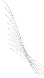
Şekil 7.16 60° Eğrilikli fırkateyn pervanesi kanat kesitleri
