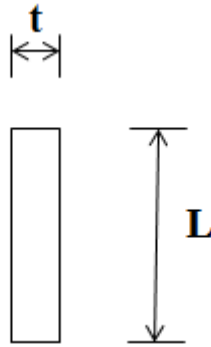
Şekil 2.3 İnce cıdarlı açık dikdörtgen profil
