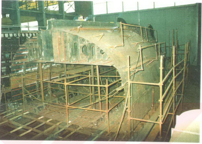
Şekil 7.6. Güverte jigi üzerinde blok imali
