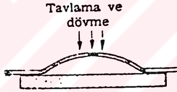
Şekil 4.25. Kalın saclarda tavlama
