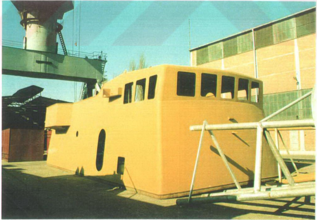
Şekil 7.9. Raspa ve astar boyası yapılmış, montaja hazır üst bina
