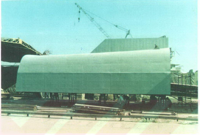
Şekil 7.8. Raspa ve astar boyası yapılmış, montaja hazır kış blok
