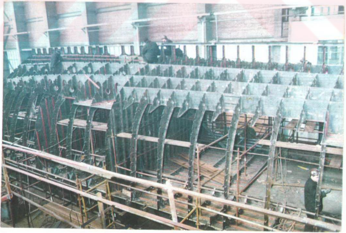
Şekil 7.7. Güverte jigi üzerinde blok imali
