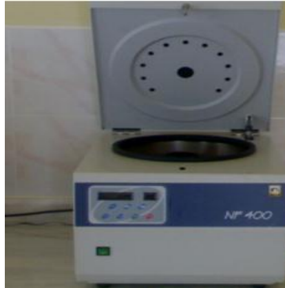
Şekil 4.4 NF 400 model santrifüj ayırıcı
