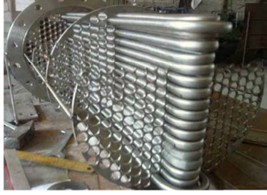
Şekil 2.14 Boruların destek levhalarını tamamen doldurduğu tip
