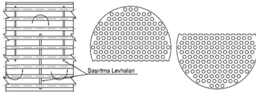
Şekil 2.11 Boruların destek levhalarını doldurduğu tip
