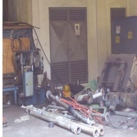
Şekil 8. 10 Makine Dairesi Boru Devrelerinde Değişen Devre Boruları (Çelebi, U.B., VARDAR, N., Gemi Onarım Sektörünün Çevre Kirliliğine Etkisi, 2006)
