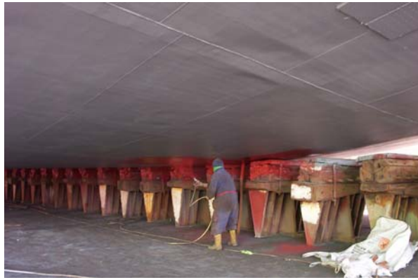
Şekil 8. 5 Dip Boya Uygulama İşlemi (Çelebi, U.B., VARDAR, N., Gemi Onarım Sektörünün Çevre Kirliliğine Etkisi, 2006)
