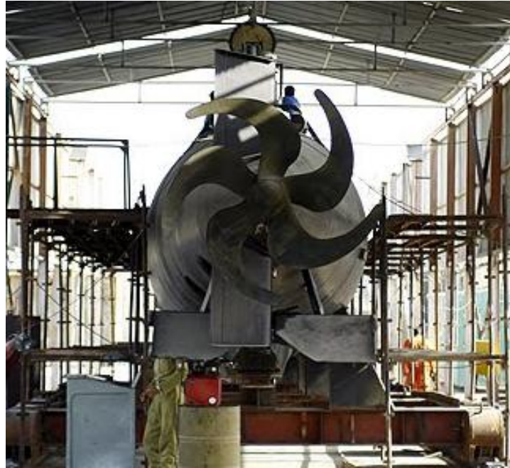
Şekil 2. 2 İran donanmasına ait yüksek çalıklı bir denizaltı pervanesi [5]
