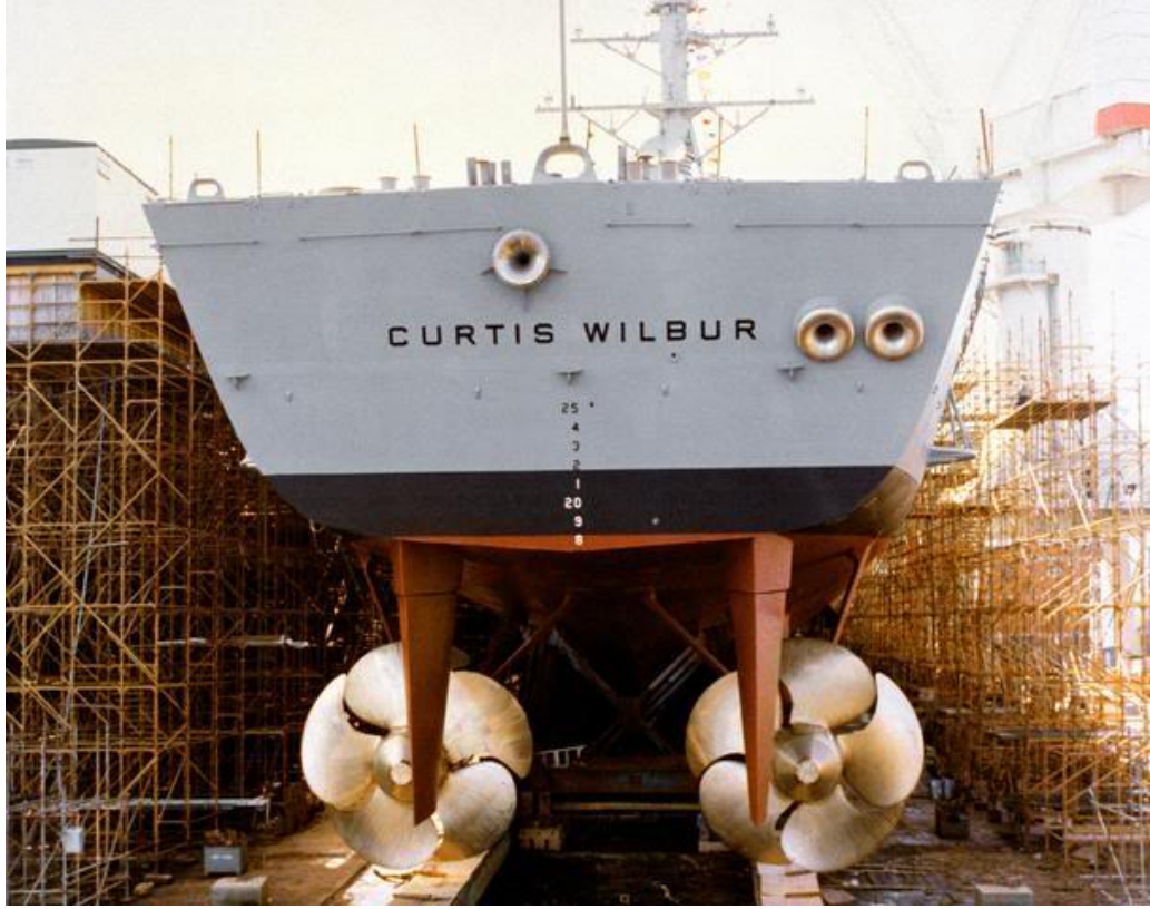
Şekil 3. 13 ABD donanmasına ait bir destroyerde çalıklıklı pervane uygulaması [36]
