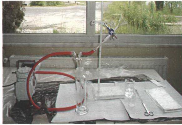
Şekil 3.110 \text{ZrO}(\text{H}_2\text{PO}_4)_2 kolon ile hazırlanan \text{Cs-137/Ba-137m} jeneratörü
