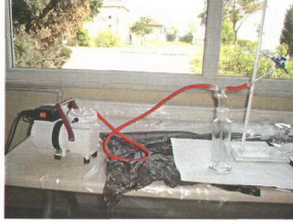
Şekil 3.123 \text{Cu}_2[\text{Fe}(\text{CN})_6] kolon ile Cs-137/Ba-137m jeneratörü
