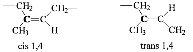
Şekil 2.6 Poli( 1,4-isopren) cis- ve trans- izomerleri (Tager, 1978)
