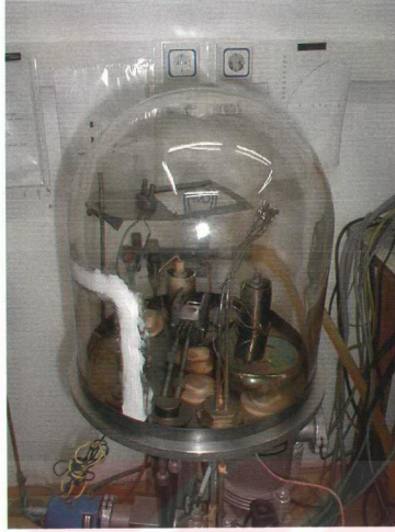
Şekil 2.3 GS üzerine Ag buharlaştırmak için kullanılan vakum tüpü (Katıhal Elektronik Araştırma Laboratuvarı, YTÜ)
