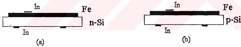
Şekil 2.3 (a) 1. tür Fe / n-Si ve (b) 2. tür Fe / p-Si eklemler ( T_{alt}=25^{\circ}C )
