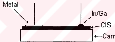
Şekil 2.12 Akım-Gerilim karakteristiği ölçümü için hazırlanan numune.
