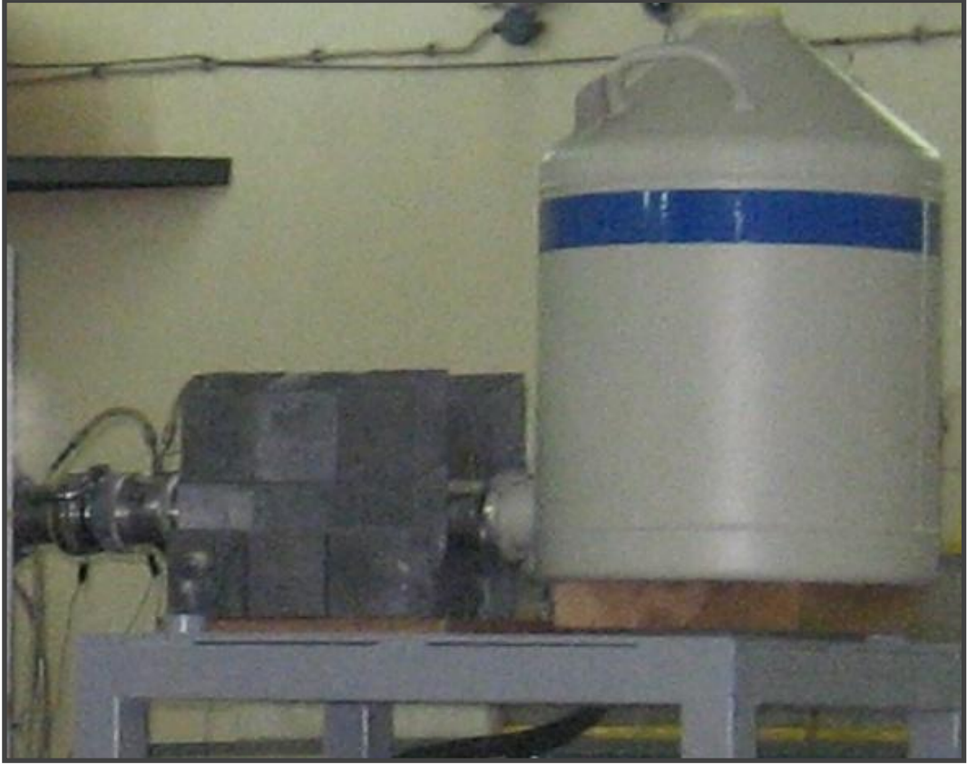
Şekil 3. 3 Kurşun zırh içinde Ge detektör
