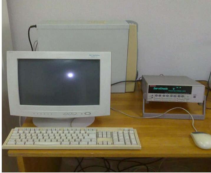
Şekil 3.4 I-V Karakteristiklerinin Ölçülmesinde Kullanılan Deneysel Düzenek
