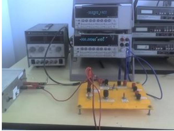
Şekil 3.15 YTÜ Fizik Bölümü Katıhal Elektroniği Laboratuvarında bulunan akım-gerilim karakteristiği ölçüm sistemi.
