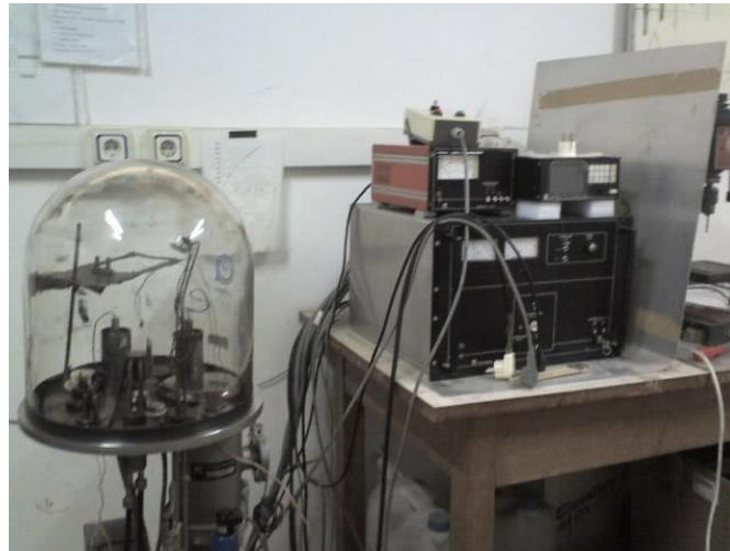
Şekil 3.11 YTÜ Fizik Bölümü Katıhal Elektroniđi Laboratuvarında bulunan elektron demeti Buharlaştırma Vakum Sistemi.
