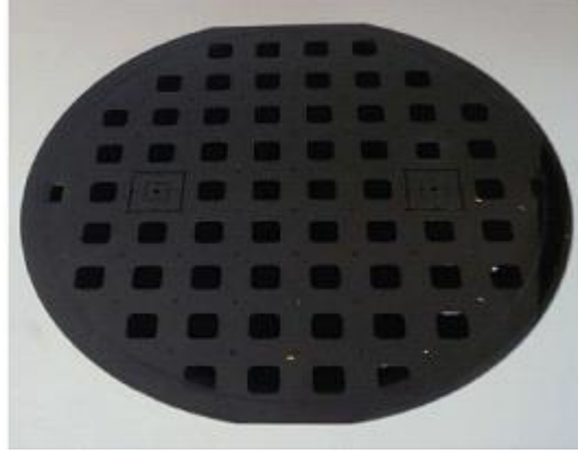
Şekil 1.13 Gözenekli silisyum zarlarının mikroüretilmiş waferi.
