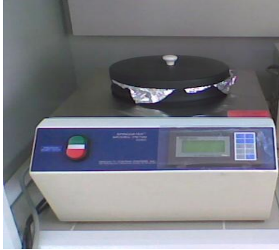
Şekil 3.6 İnce film kaplamak için kullanılan dönel kaplama (spin coating ) cihazı
