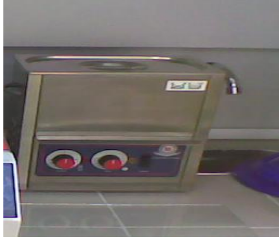
Şekil 3.4 Altlıkların temizleme işleminde kullanılan ultrasonik banyo cihazı
