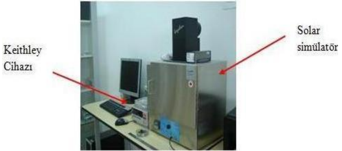
Şekil 3.9 Akım-gerilim karakterizasyonu için keithley 2400 ve solar simülatör cihazı
