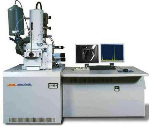
Şekil 3.7 JEOL 7000F FEG-SEM Model Taramalı Elektron Mikroskobu
