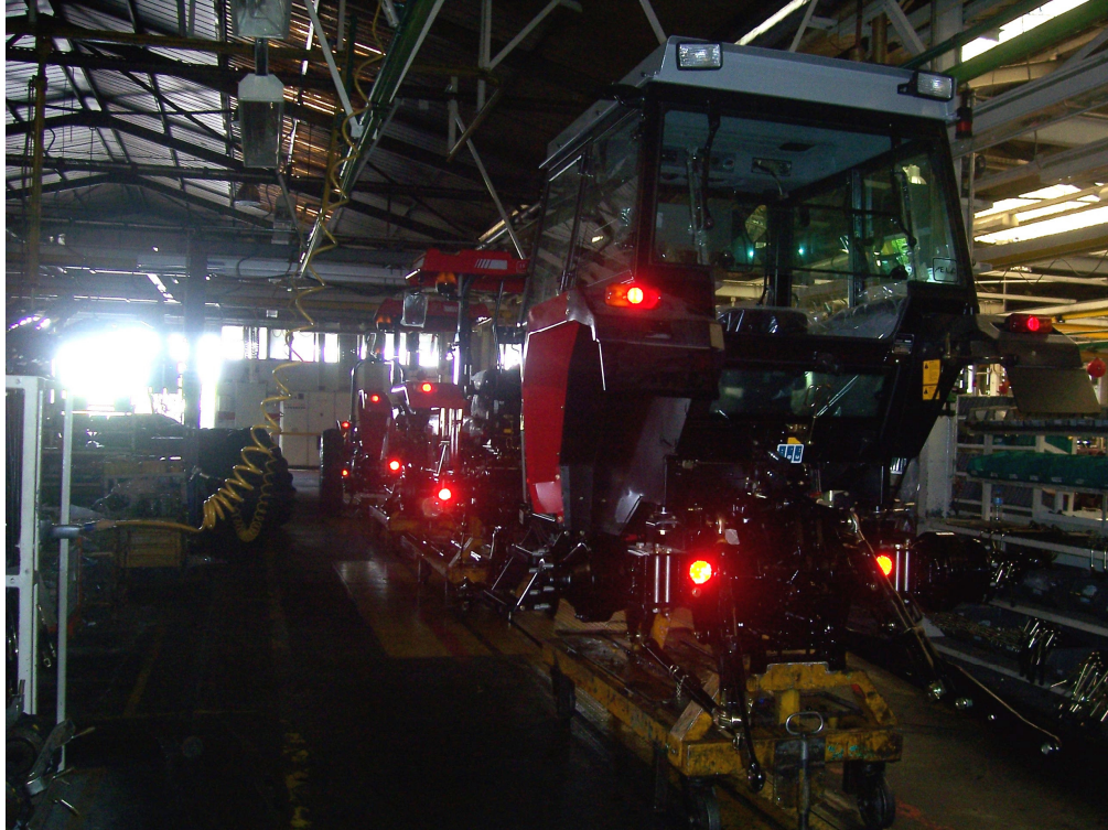
Şekil 6.21. Kaputun montajından sonra üretim hattının ilerleyişi
