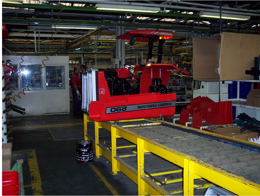
Şekil 6.17. Kaputun konveyörlü sistem üzerinde ilerleyişi
