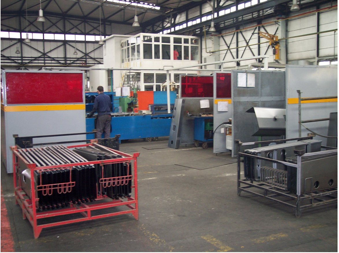
Şekil 6.5. Saç atölyesi kaput hücresi; hücre u-tipi haline getirilmiş
