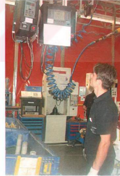
Resim 5.9 Monitörler için pnömatik askı sisteminin kurulması
