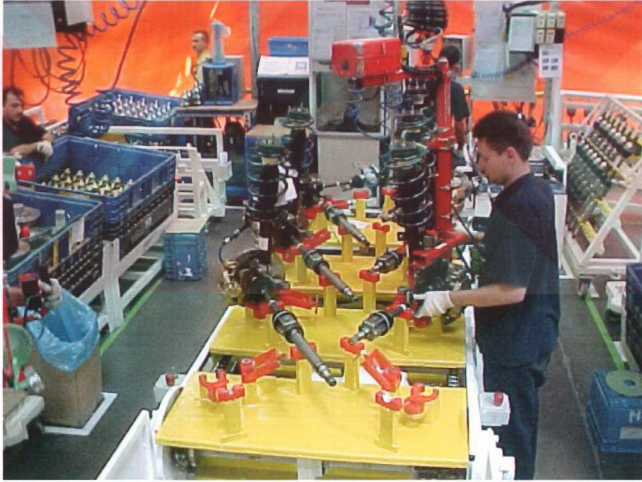
Resim 5.2 Tek parça akışını sağlayan konveyör
