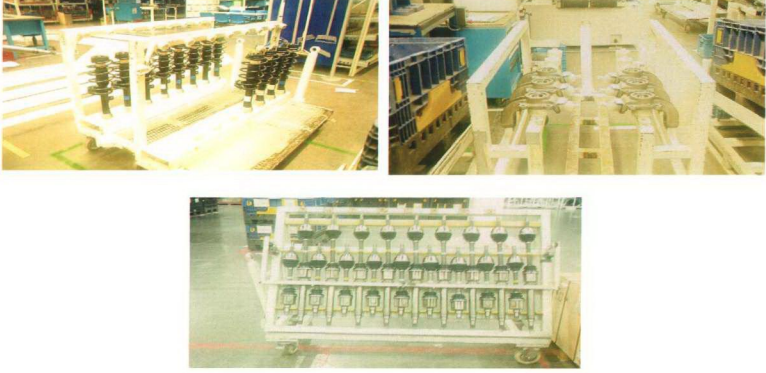
Resim 5.4 Sıralı Malzeme İkmalinden Sonra Hat Yanı Malzeme Stoğu
