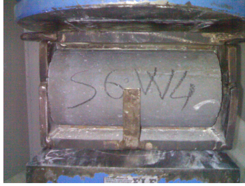
Şekil 3.14 Suda soğutulan numunede yarma deneyi
