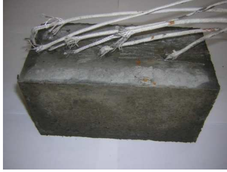
Şekil 3.11 Derinliğe bağlı sıcaklık değişimi ölçümü yapılacak numune
