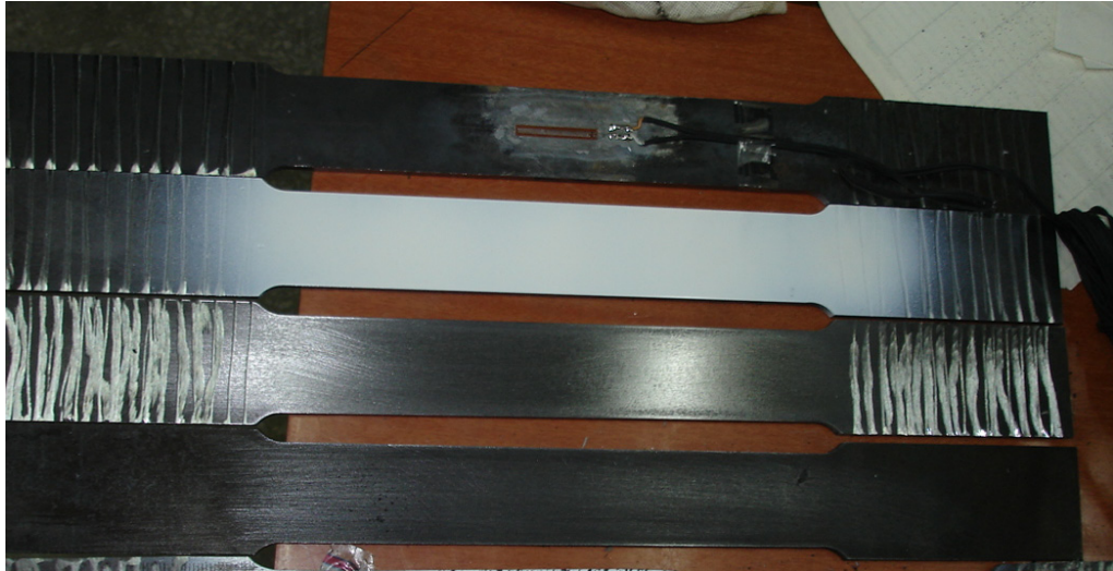
Şekil 4.3 Temizlenmiş ve boyanmış örnekler.
