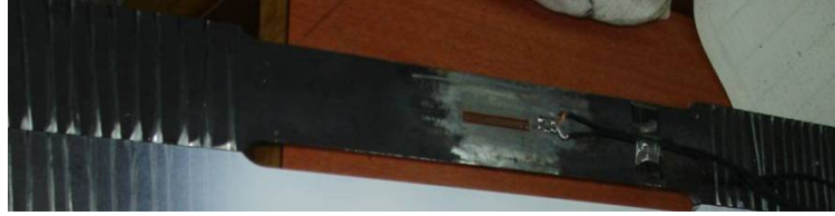
Şekil 4.14 Üzerine şekil değiştirme ölçer yapıştırılmış standart örnek.
