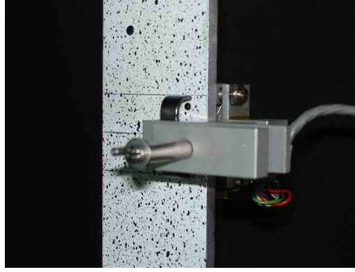
Şekil 4.10 Örnek üzerine bağlı ekstensometre.
