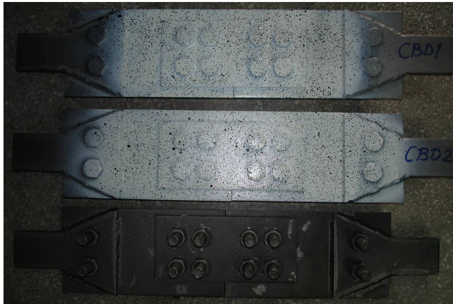
Şekil 5.16 Dar ek levhalı bulonlu (cıvatalı) birleşim örnekleri.
