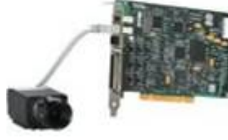
Şekil 4.8 Fire Wire iletişim portu ve kartı.
