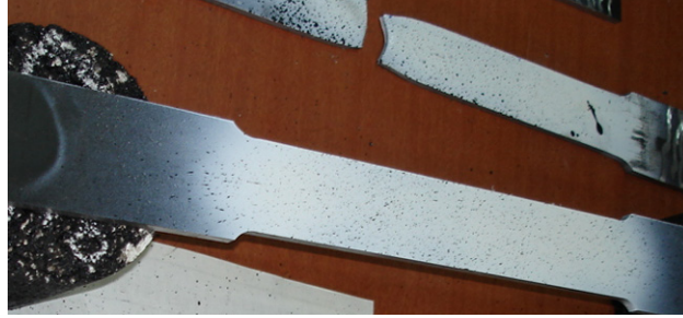
Şekil 4.5 Siyah ahşap boyası ile üzerine desen oluşturulmuş örnekler.
