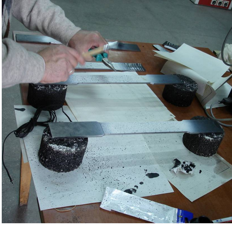
Şekil 4.4 Boyanmış örnekler üzerine siyah ahşap boyası ile desen oluşturulması.
