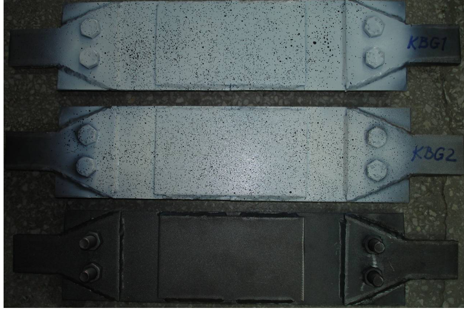
Şekil 5.10 Geniş ek levhalı kaynaklı birleşim örnekleri.
