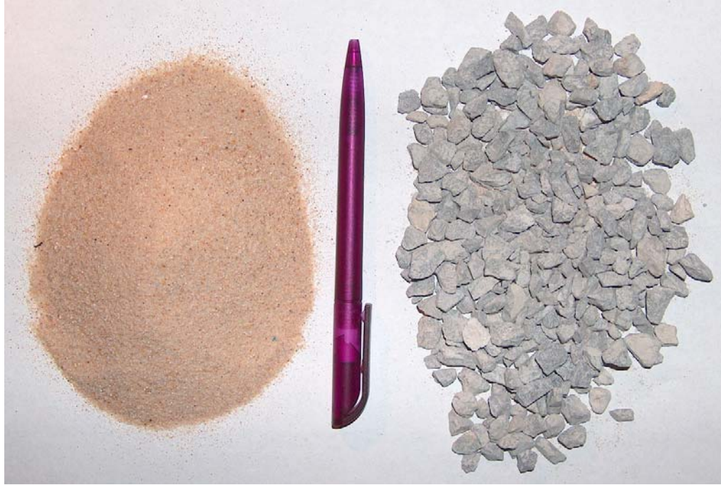
Şekil 6.1 Geri Dolgu Malzemesi Olarak Kullanılan Zeminler
