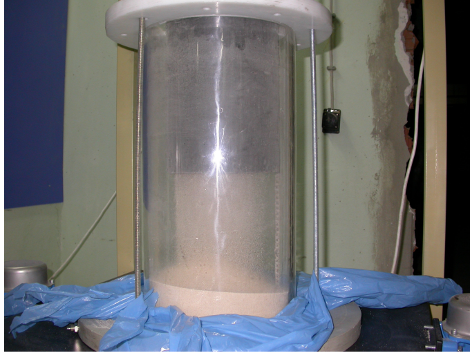
Şekil 5.8. Kumun Pleksiglas Silindir İçerisine Yağmurlanması
