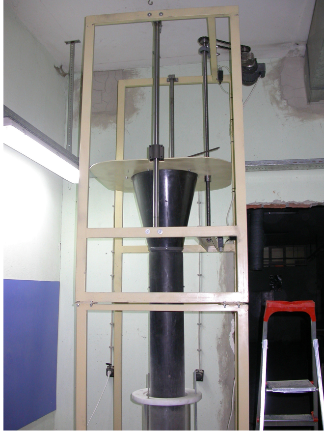
Şekil 5.7. Kum Yağmurlama Sistemi
