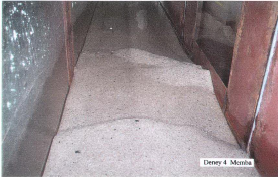
Şekil 7.25 b V_1=0.78 m/s için taban topoğrafyasının membadan görünüşü
