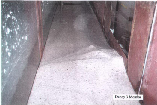
Şekil 7.23 b V_1=0.59 m/s için taban topoğrafyasının membadan görünüşü
