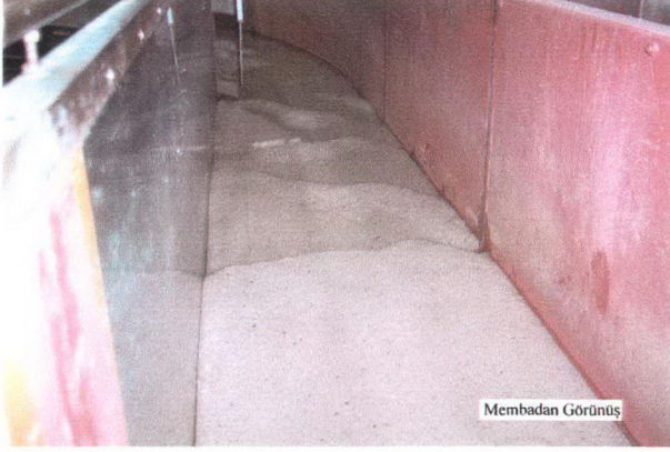
Şekil 7.63a Kıvrımlı kanalda ( \theta=30^\circ ) V_1=0.99 m/s için yan savağın membasında oluşan taban dalgalarının görünümü
