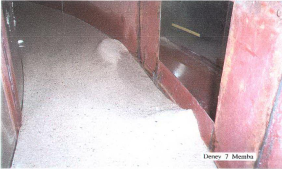
Şekil 7.56b Kıvrımlı kanalda ( \theta=30^\circ ) V_1=0.38 m/s için taban topoğrafyasının membadan görüntüsü
