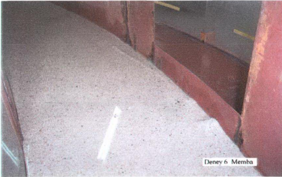
Şekil 7.54b Kıvrımlı kanalda ( \theta=30^\circ ) V_1=0.31 m/s için taban topoğrafyasının membadan görünüşü
