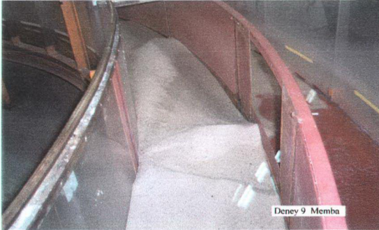
Şekil 7.60b Kıvrımlı kanalda ( \theta=30^\circ ) V_1=0.78 m/s için taban topoğrafyasının membadan görünüşü
