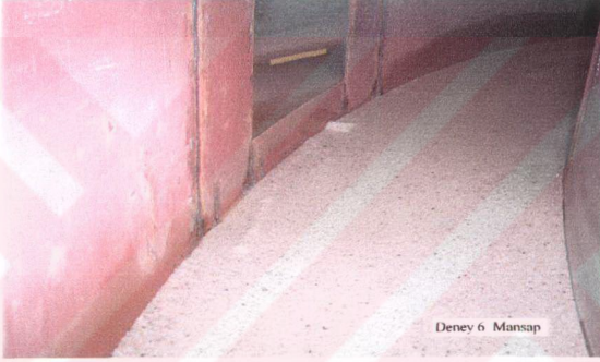
Şekil 7.54a Kıvrımlı kanalda ( \theta=30^\circ ) V_1=0.31 m/s için taban topoğrafyasının mansaptan görünüşü
