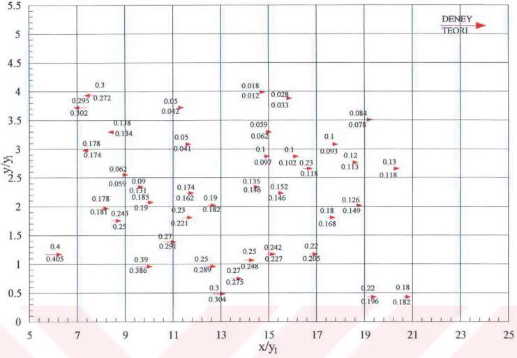
Şekil 5.17 Fr_1=3.99 ve \theta=30^\circ jetli hidrolik sıçramada hız alanı (eğimli kanal s=\frac{0}{100} 4 ) ( \rightarrow Hız vektörü (m/sn))
