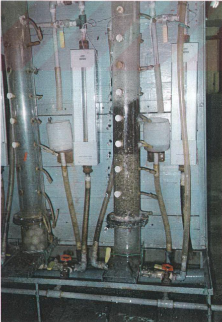
Resim 6.7. Malzemelerin, Düşük Geri Yıkama Hızıyla Yapılan Geri Yıkınması Haalindeki Davranışı Daha Az Bir Kabarma Gösteriyor.
