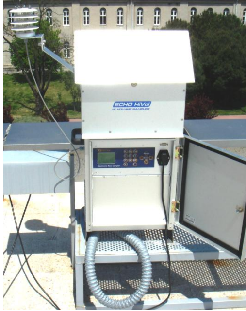
Şekil 2.2 Yüksek hacimli hava örnekleyici
