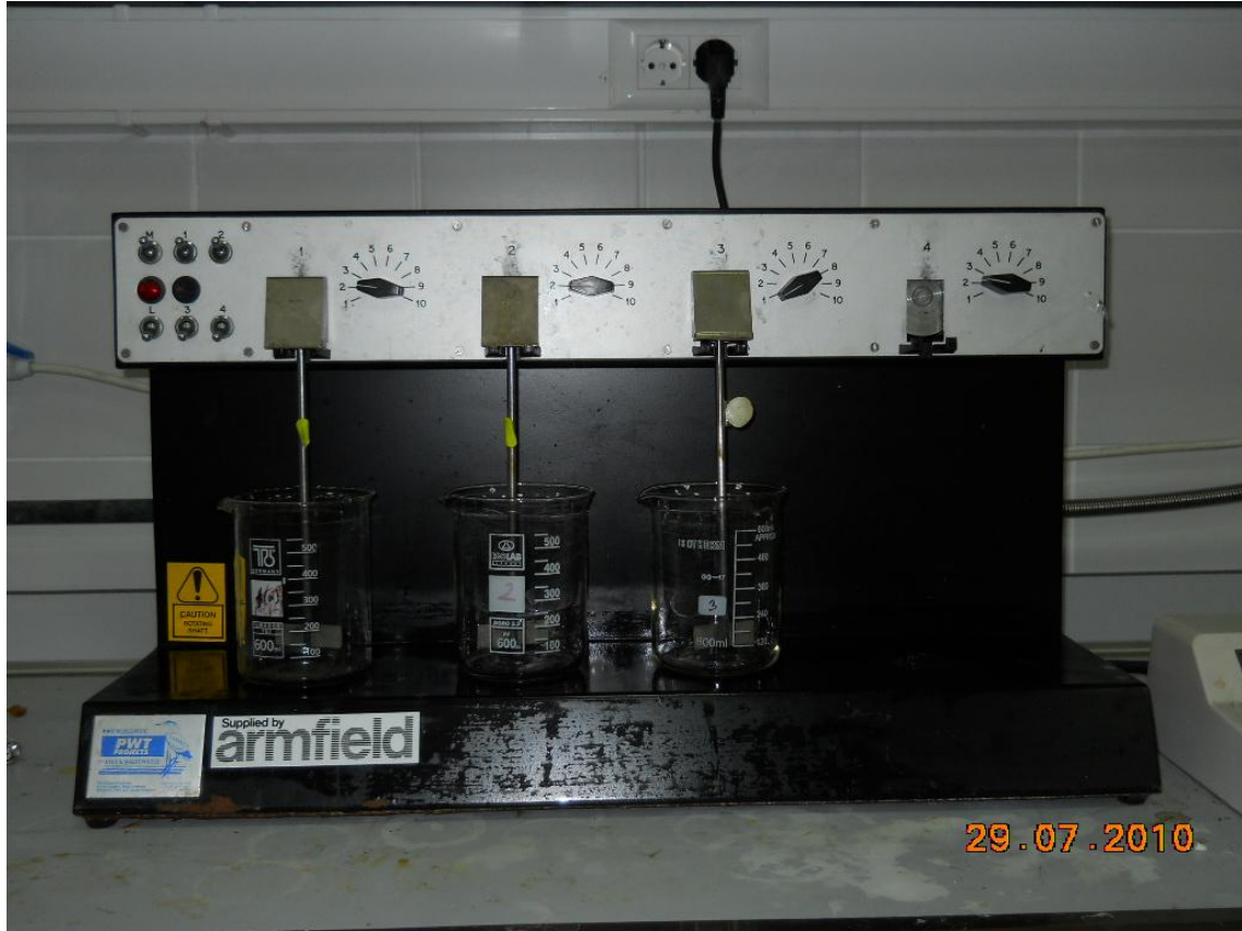
Şekil 3.4 Çalışmada kullanılan jar test düzeneği
