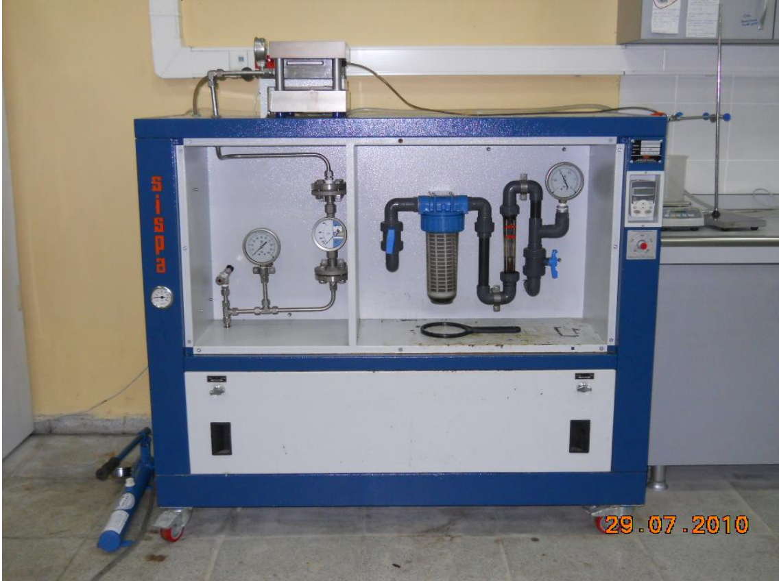
řekil 3.6 Çalıřmada kullanılan membran düzeneđi
