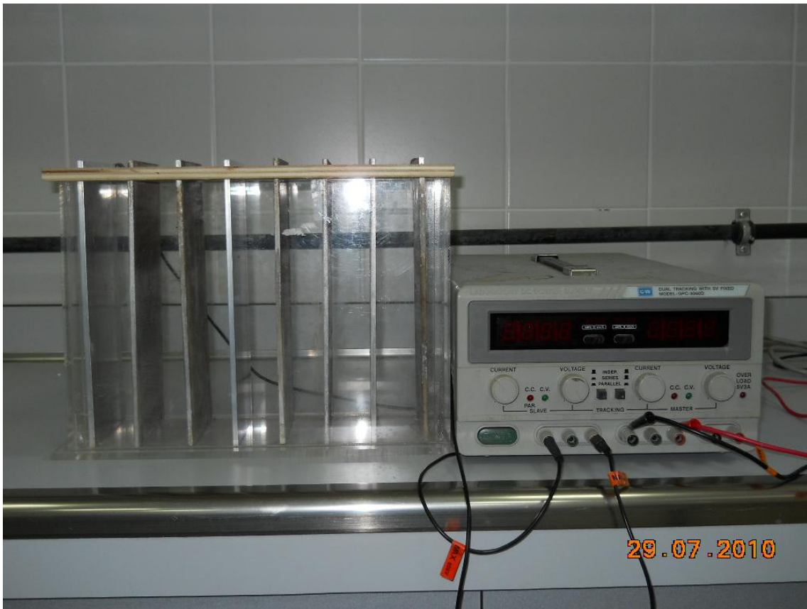
Şekil 3.5 Elektrokoagülasyon ve elektrooksidasyon düzeneği
