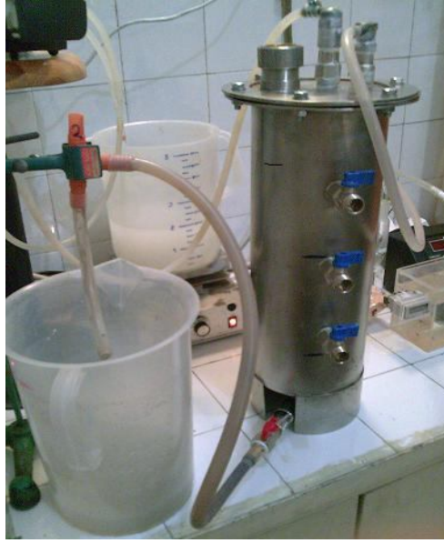
Şekil 3.1 Krom çelikten yapılmış anaerobik reaktör
