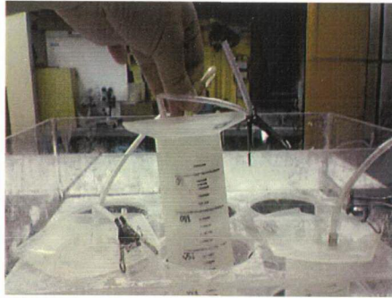
BMP ve Biyoayrışamayan KOİ deneyleri için kullanılan kesikli reaktörler
