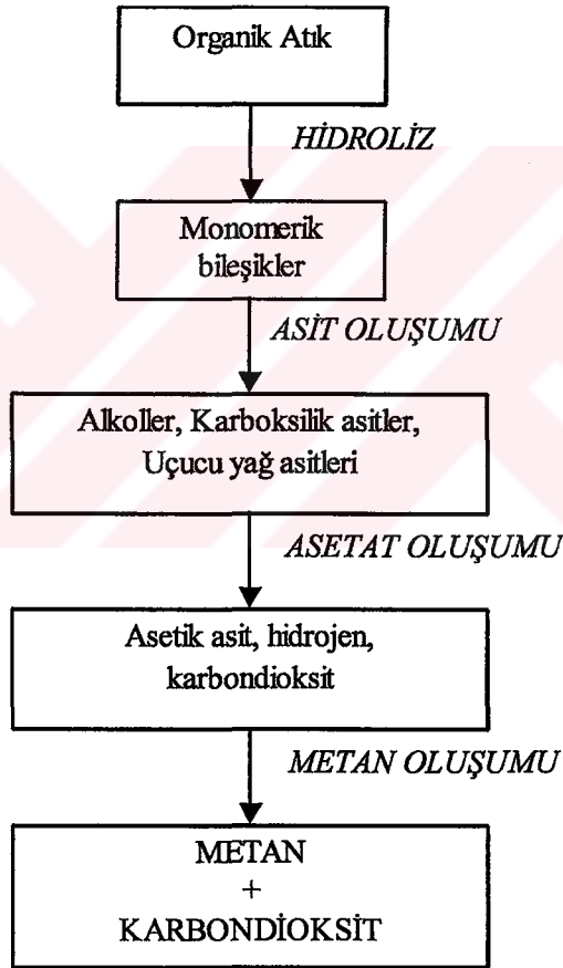
Şekil 2.4 Anaerobik ayrışma kademeleri
