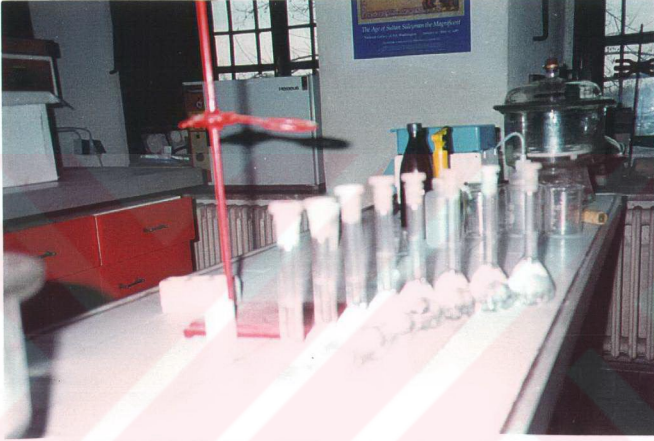
Şekil 5.19. Seçilmiş örneklerin, suda çözünen tuzların analizi için balon joje içinde stok çözeltilerinin hazırlanması.
