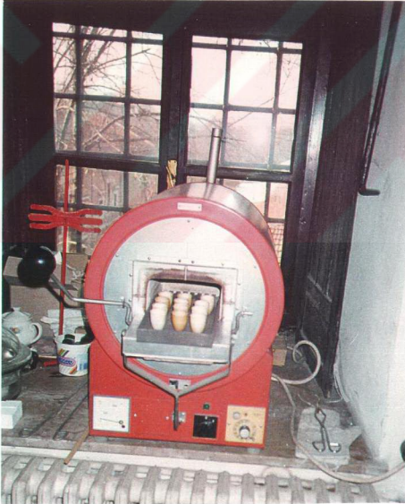
Şekil 5.17. Öğütülmüş örneklerin tartılıp porselen kroze içinde (Heraus ) fırında bekletilmesi.
