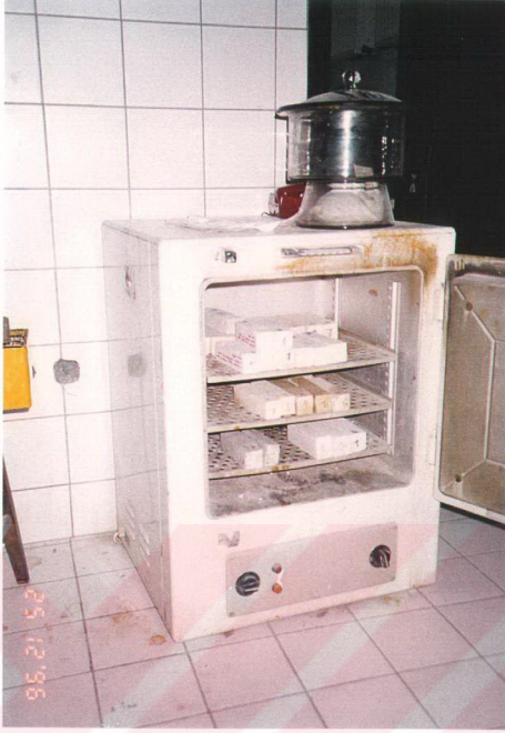
Şekil.5.32. Örneklerin kılcal su emme deneyi için Heraus marka etüvde değişmez kütleye kadar kurutulması.
