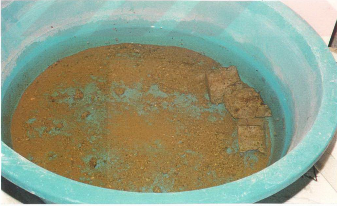
Şekil 6.16. Don deneyi sırasında derin soğutucudan çıkarılarak suya koyulan örnek 6-3 den dökülen parçalar.
