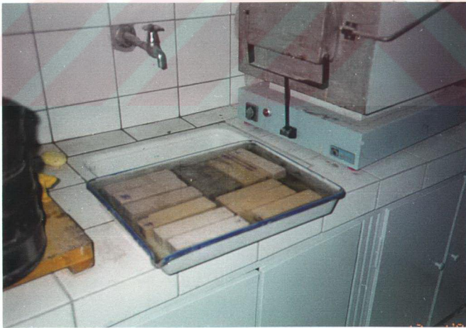
Şekil 5.31. Kılcal su emme tayini için seçilmiş örneklerin su ile yıkanarak temizlenmesi.
