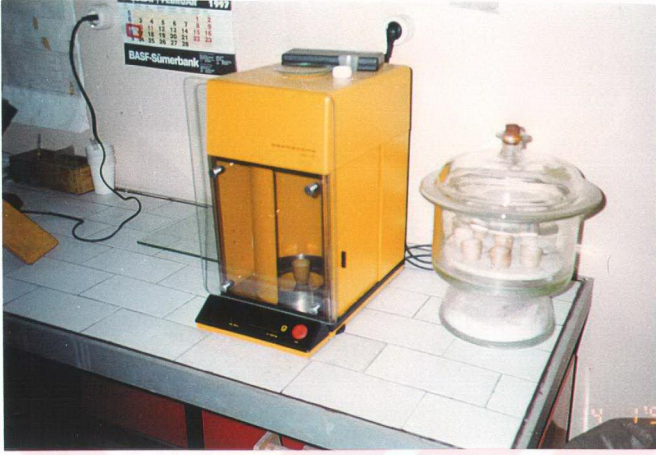
Şekil 5.18. Örneklerin desikatörde soğutulup laboratuvar terazisinde (Sartorius L2200S) tartılması.
