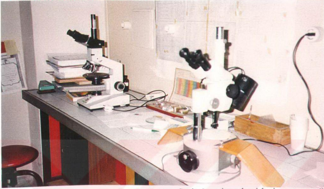
Şekil 5.21. Polarizan mikroskopa (James Swit ) ve ince kesitlerin petrografik, stereo mikroskopa (Olympus 8) kalın dilimlerin doku analizleri.
