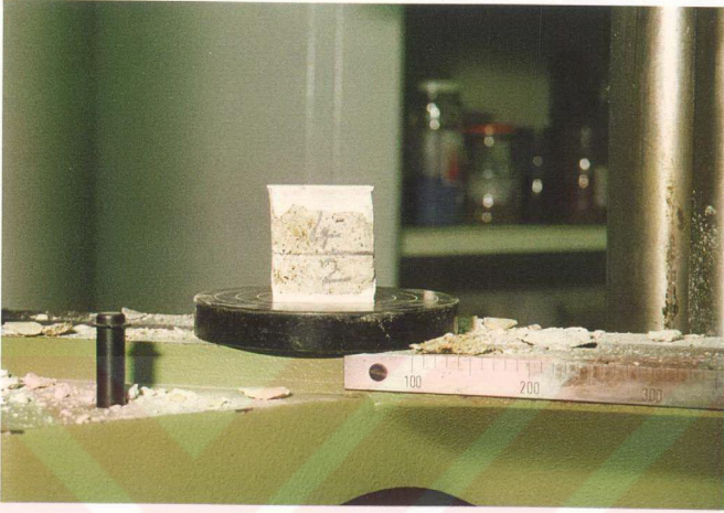
Şekil 5.45. Örnek 6. Basınç dayanımı deneyinde, malzemenin deney presi tablaları arasına yerleştirilmesi (İ.T.Ü. M.F.Y.M.B.D.L.'da verilen 4 numara gerçekte 6'dır.).
