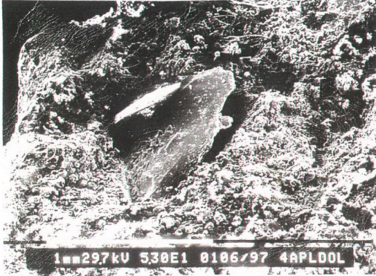
Şekil 6.10. Örnek 5. Örneğin birinci tabakasında SEM fotoğrafında ortoklas minerali görülmektedir (SEM, Philips XL 505.) ( Venedik'teki Artistik ve Tarihi Değerleri Korumak için Kurulmuş Fen Laboratuvarında verilen 4 A numarası gerçekte 5 dir) .
