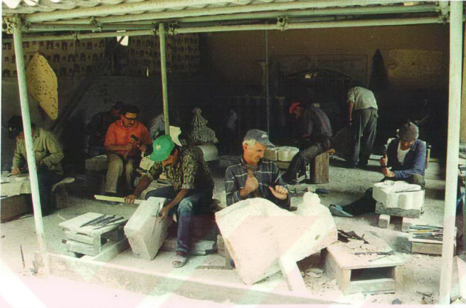
Şekil 4.20. Milli Saraylar Daire Başkanlığı bünyesinde bulunan taş atelyesinde taş yapı malzemeleri uygulama kural ve yöntemlerine uygun üretilmektedir.
