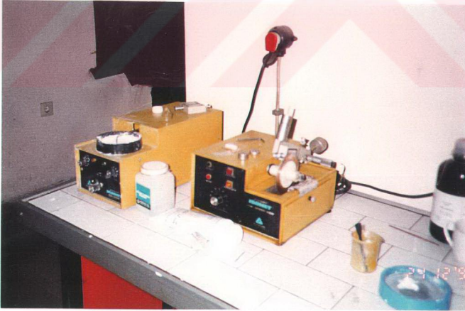
Şekil 5.20. İnce kesitlerin hazırlanması için örneklerin düşük hızlı kesici(Buehler, Isomet) ile kesilmesi ve parlatici (Buehler, Minimet) aletle parlatma işlemleri.
