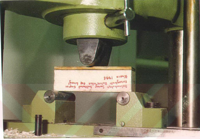
Şekil 5.35. Örnek 1. Eğilme dayanımı deneyinde, malzemenin deney presi tablaları arasına yerleştirilmesi .
