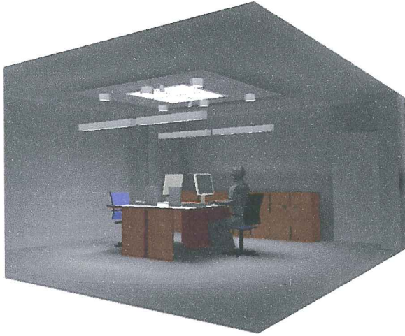
Şekil 7. 62 DIALux aydınlatma programında oluşturulan model hacim
