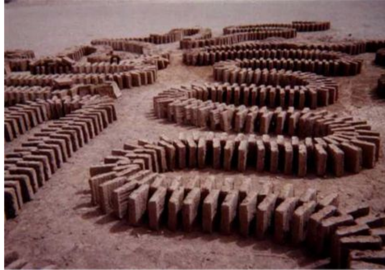
Şekil 3.12 Kerpiç blokların kurutulma şekli
