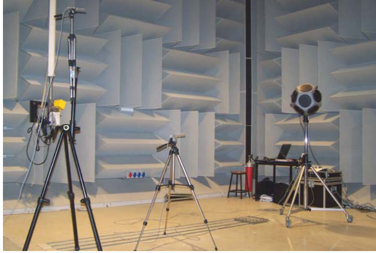
Şekil 4.11 İTÜ OTAM YYH’de engelsiz durumda ölçme düzeneği
