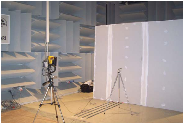
Şekil 4.12 İTÜ OTAM YYH’de oluşturulan engel ve alıcılar
