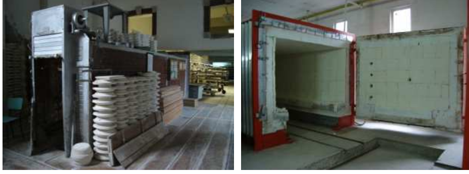
Şekil 3.105 ve 3.106 Yıldız Çini Fabrika-i Hümayunu'nda elektrikle ve doğalgazla çalışan fırınlar (Nevra Ertürk Arşivi, 2007)
