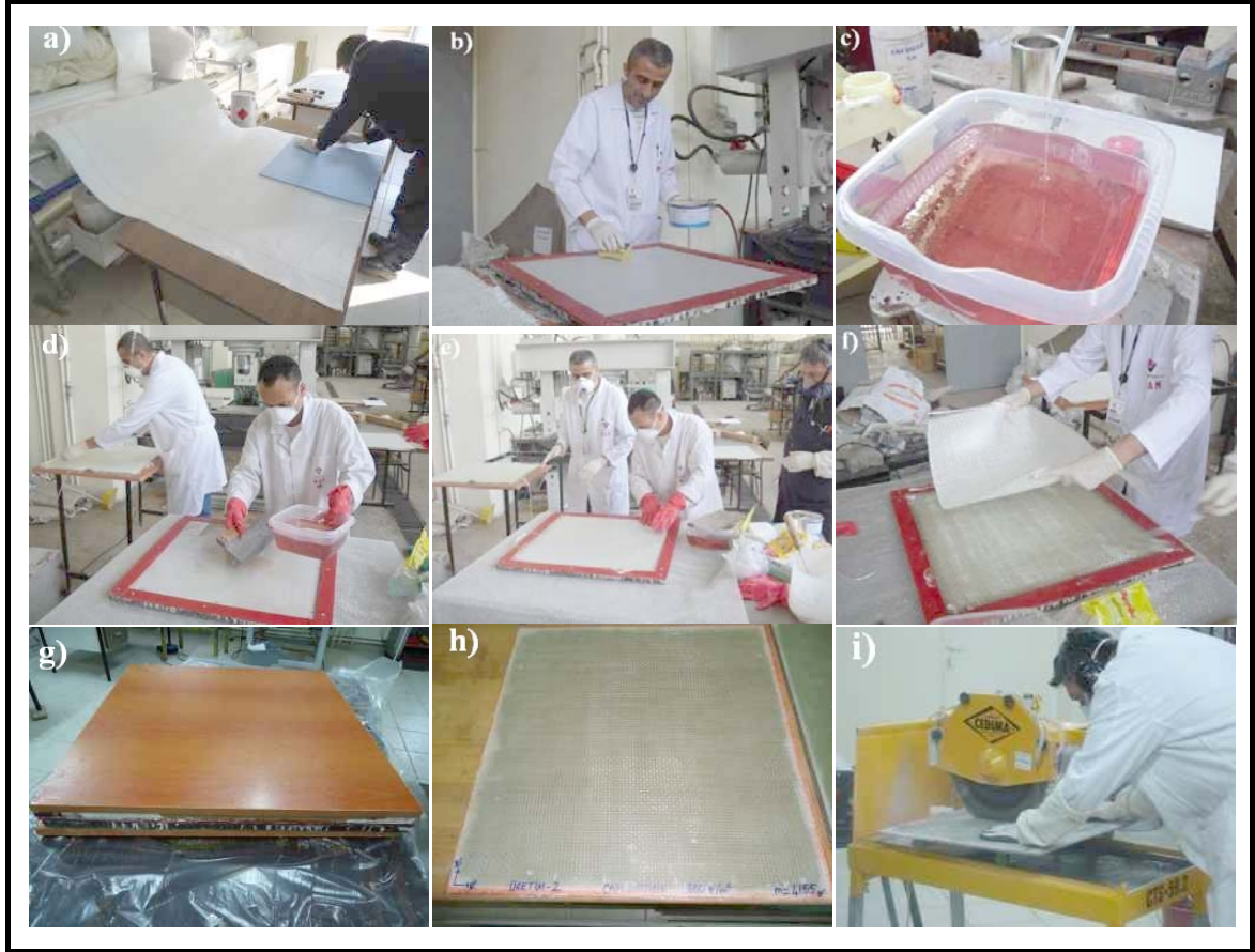
Şekil 6.3 a)Kumaş kesilmesi, b) Kalıp ayırıcı tatbiki, c) Karışım hazırlanması, d) Kalıba karışımın dökülmesi, e) İlk kat kumaşın serilmesi, f) Son katın serilmesi, g) Kalıbın kapatılması, h) Kalıptan çıkan ürün, i) Üründen numune hazırlanması
