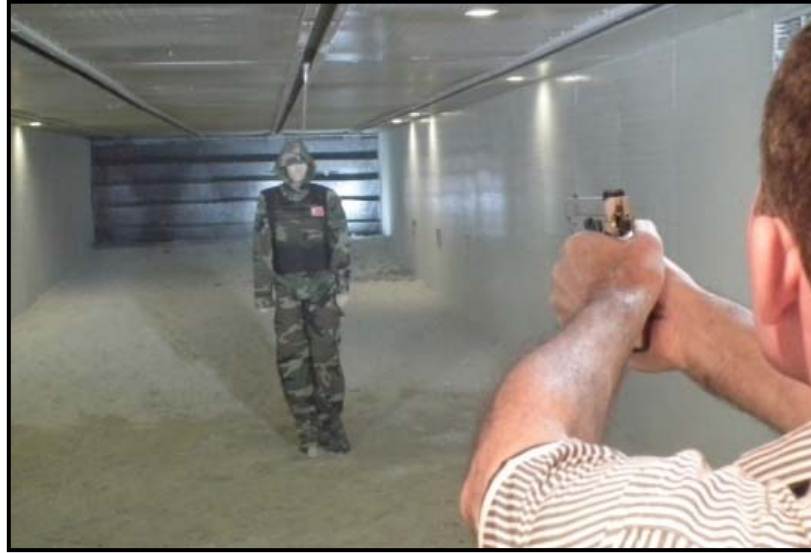
řekil 7.92 Kurřungeirmez kompozit malzeme zerine yapılan balistik atıř
