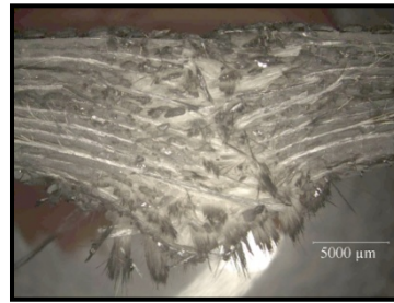
Şekil 7.78 El yatırması yöntemiyle, 0°/90° yönlü-iki eksenli-cam elyaf dikişli kumaşla ve Polipol 3401 polyesterle üretilen kompozitin (LT2) 700J darbeden sonraki görüntüsü
