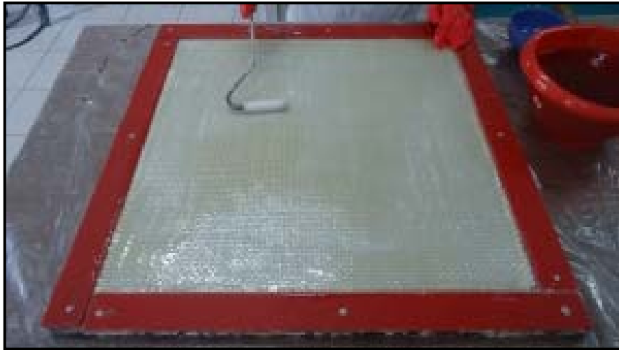
Şekil 3.1 Reçinenin ruloyla kumaşa emdirilmesi
