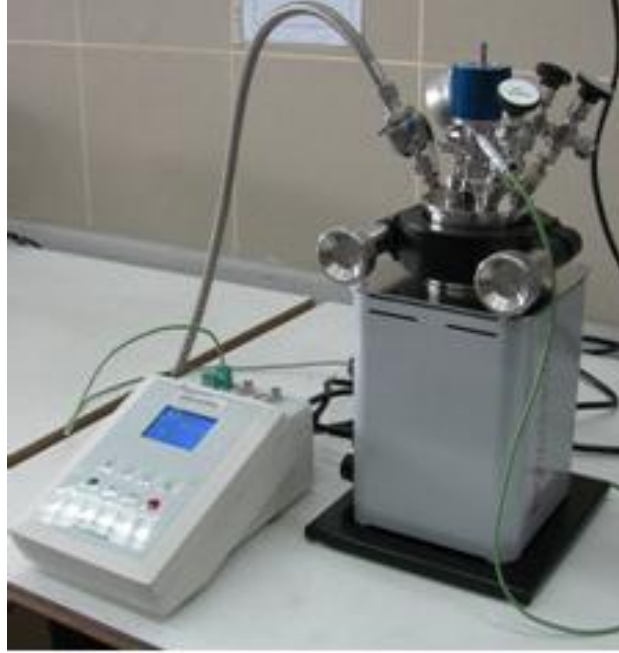
Şekil 3.4 Hidrotermal proses ile HA üretiminde kullanılan reaktörün resmi
