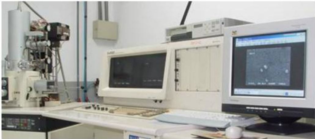
Şekil3.12 Morfolojik analiz için kullanılan Taramalı Elektron Mikroskobu (SEM)
