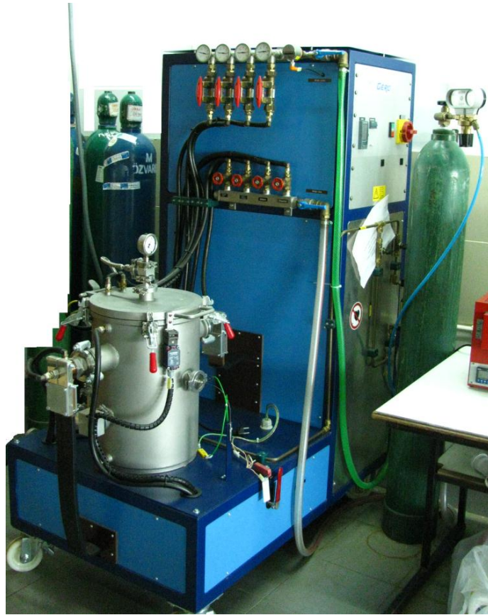
Şekil 3.16 Sinterleme işleminde kullanılan vakum fırın
