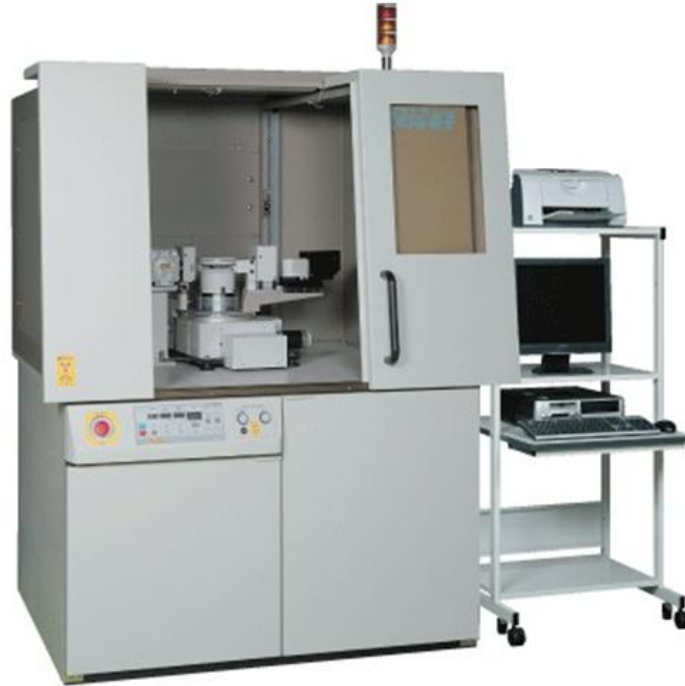
Şekil 3.9 Karakterizasyon çalışmalarında kullanılan X ışınları kırınım cihazı
