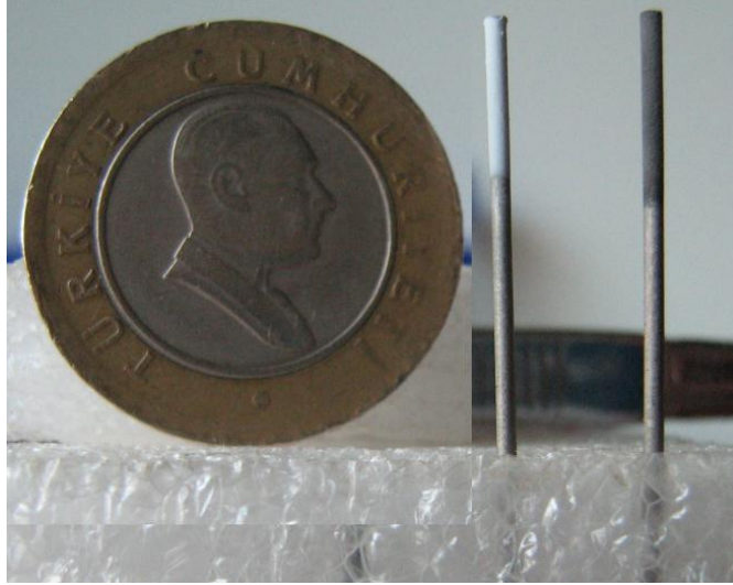
Şekil 4.50 HHA-2 ve HHA-2/KNT tozlarının EKB yöntemi ile Ti6Al4V teller üzerine kaplandıktan sonraki fotoğrafları
