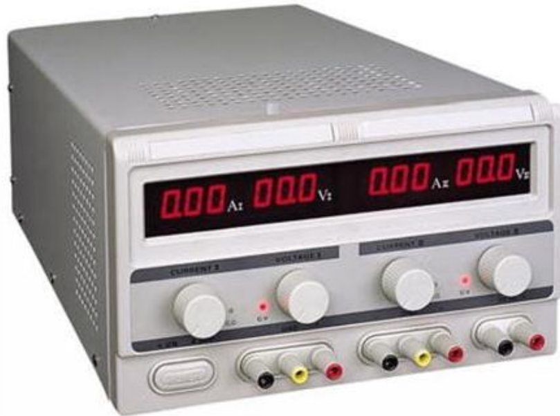
Şekil 3.8 Kaplama çalışmalarında kullanılan DC güç kaynağı
