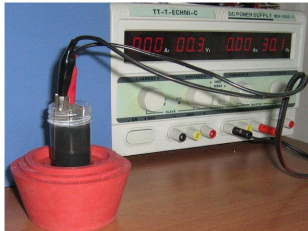
Şekil 4.48 EKB deneylerinin yapıldığı kaplama düzeneği
