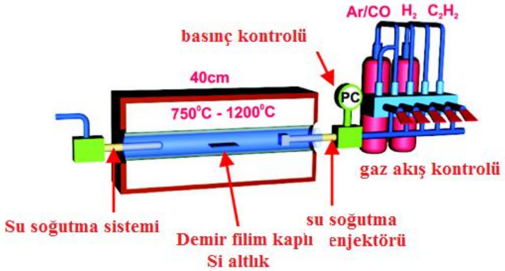
Şekil 2.12 CVD yöntemi ile KNT üretimi [79]
