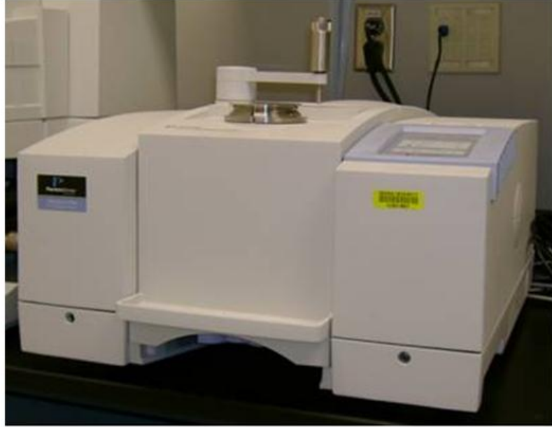
Şekil 3.10 Karakterizasyon çalışmalarında kullanılan FT-IR ATR cihazı
