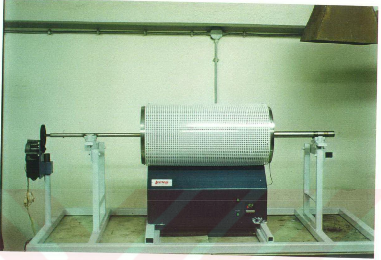
Resim 9.1 Redüksiyon deneylerinde kullanılan döner fırın.
